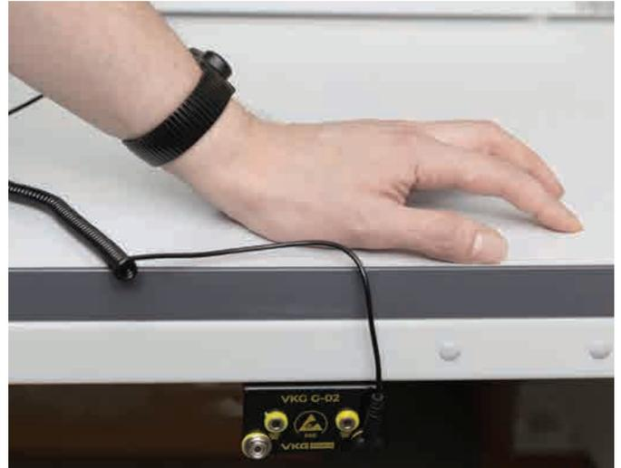
Способ стационарного заземления для персонала. Плавное стекание заряда с человека происходит через браслет и гарнитуру заземления на узел заземления. Браслеты регулируемые, эластичные, с добавлением токопроводящих нитей, гипоаллергенные. Заземляются через узел заземления VKG G-02 кнопками 10 мм или разъемами типа «банан».
