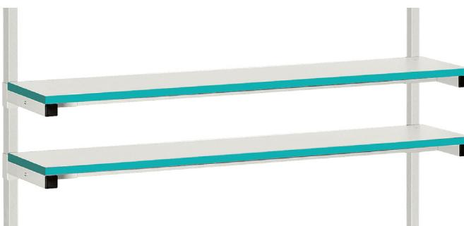
Сервисные надстройки для лабораторных столов Классик LAB поставляются в комплекте с одной или двумя полками глубиной 300 или 400 мм, выполненными из ЛДСП, пластика (HPL, HPL PLUS) или полипропилена. Допустимая нагрузка на полки до 50 кг.
