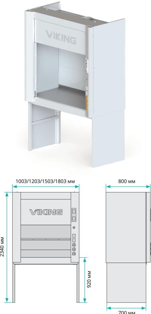
Вытяжные металлические шкафы LLC-MF VIKING LAB предназначены для установки муфельных печей и сушильных шкафов.
