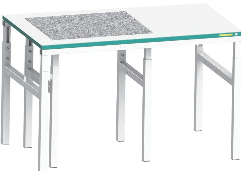
**Стол весовой лабораторный комбинированный СВК-х-7 LAB** состоит из стола весового СВ/Г-6-5 LAB с гранитной плитой толщиной 30 мм и стола универсального. В своей основе стол имеет прочный металлический каркас, покрытый химически стойкой краской, который регулируется по высоте от 650 до 900 мм и выдерживает нагрузку до 300 кг.
