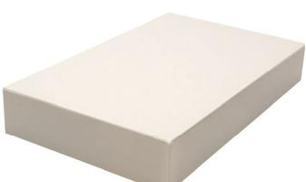
**CERAMIC GRANITE PRO** — монолитная плита толщиной 20 мм, обладает высокой прочностью, низким водопоглощением, устойчивостью к износу и перепадам температур, выдерживает воздействие температур более 180° С. Материал устойчив к воздействию щелочей, органических растворителей и концентрированных кислот, за исключением плавиковой кислоты.
