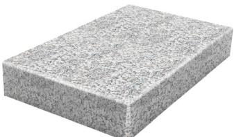
**НАТУРАЛЬНЫЙ ГРАНИТ** — прочный и долговечный природный камень. Толщина 30 мм. Материал обладает устойчивостью к воздействию высоких температур и влажности, имеет низкий показатель истираемости 0,4 г/см<sup>2</sup>. Средняя плотность: 2710 кг/м<sup>3</sup>.
