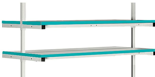
Сервисные надстройки для островных столов поставляются в комплекте с одной полкой (входит в базовую комплектацию) или двумя полками (заказывается отдельно), глубиной 300 или 400 мм, выполненные из ЛДСП, пластика (HPL, HPL PLUS) или полипропилена. Допустимая нагрузка на полки до 50 кг.
