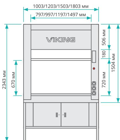
Вытяжные шкафы имеют в верхней части отверстие с фланцем диаметром 200 мм для подключения к системе вентиляции. Нижняя тумба изготавливается из металла и поставляется отдельно.
