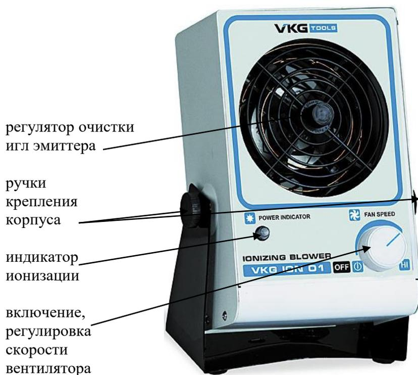
Включение **VKG ION 01** осуществляется поворотом регулятора скорости вентилятора по часовой стрелке. После включения должен загореться индикатор ионизации, свидетельствующий о наличии ионизированного воздуха. Установите желаемую скорость потока воздуха с помощью регулировки скорости вращения вентилятора.
